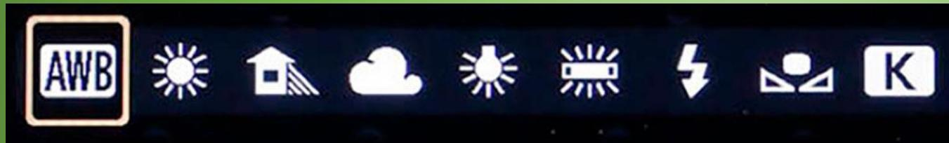
Durch die Einstellung eines WB-Symbols trifft der Fotograf eine Vorauswahl die bei der Berechnung des Weißabgleichs in der Kamera berücksichtigt wird.
